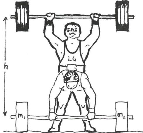
Mechanische Arbeit wird verrichtet, wenn die Kraft auf den Körper in Richtung des zurückgelegten Weges wirkt.
